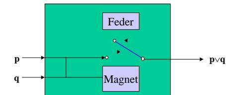
Abbildung 16: Schematische Darstellung eines zweistelligen ODER-Gatters, das am Ausgang nur dann Null liefert, wenn beide Eingangsgrößen nicht unter Strom stehen.
