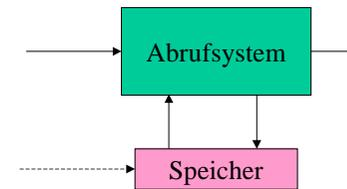
Abbildung 6: Beispiel für ein gedächtnisgebundenes statisches System. Die Ausgangsgröße hängt von der Eingangsgröße und vom Speicherinhalt ab, der sich während des Arbeitsbetriebes nicht verändert, aber über einen separaten Prozess geladen werden kann.
