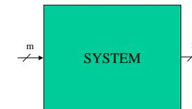
Abbildung 5: Binäres System mit einem  $m$  Bit breiten Eingangs- und einem  $n$  Bit breiten Ausgangskanal. Die jeweilige Wortbreite eines Kanals wird durch einen Schrägstrich mit der darüber gestellten Bit-Angabe charakterisiert.
