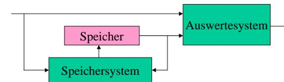
Abbildung 7: Beispiel für ein dynamisches System. Die Eingangsgröße sowie der jeweilige Speicherinhalt wird über das Auswertesystem in eine Ausgangsgröße umgewandelt. Gleichzeitig ermittelt das Speichersystem aus der Eingangsgröße und dem alten Speicherinhalt den neuen Speicherinhalt. Die Ausgangsgröße hängt somit nicht nur von der Eingangsgröße ab, sondern auch von der im Speicher festgehaltenen Vorgeschichte des Systems.
