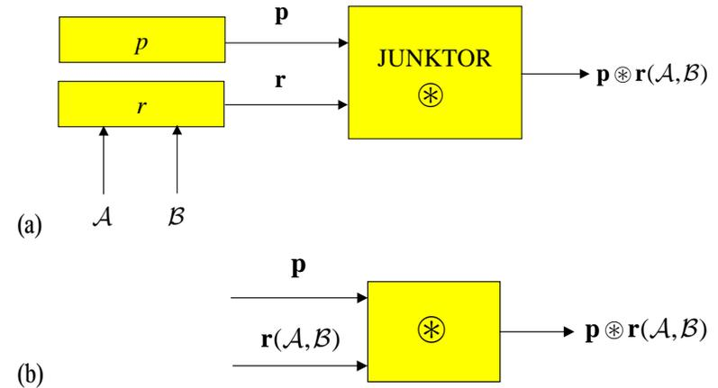
Abbildung 20: Junktorkonstante  $\otimes$  verbunden mit einer Primaussage  $p$  und einer Relation  $r$ , welche die Werte  $\mathbf{p}$  bzw.  $r(\mathcal{A}, \mathcal{B})$  liefert; Relationen werden wie Primaussagen behandelt. Abbildung (b) zeigt die Kurzform der Darstellung von Abbildung (a).
