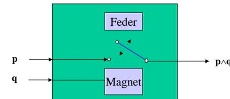
Abbildung 15: Schematische Darstellung eines zweistelligen UND-Gatters, das am Ausgang nur dann einen von Null verschiedenen Wert liefert, wenn beide Eingangsgrößen unter Strom stehen.
