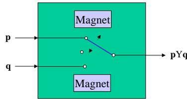
Abbildung 17: Schematische Darstellung eines zweistelligen EXKLUSIVES-ODER-Gatters, das am Ausgang nur dann Null liefert, wenn beide Eingangsgrößen gleich sind, denn dann neutralisieren sich bei einem hier nicht eingezeichneten Federmechanismus die Wirkungen der beiden Magneten.
